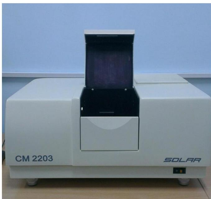
Рисунок 5 – Внешний вид спектрофотометра CM 2203
